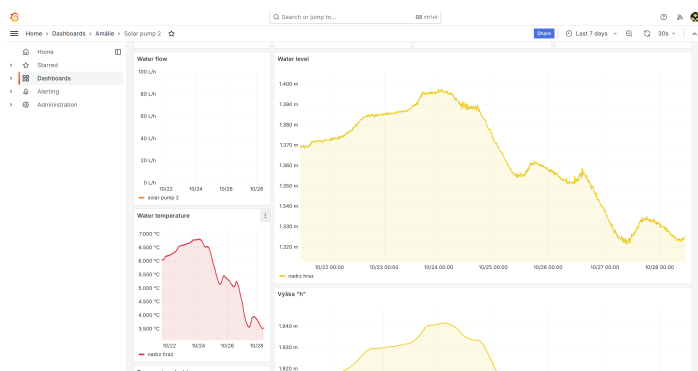
Obrázek 2.6: Zobrazení časového průběhu hladiny v nádrži pro odběry vody.
